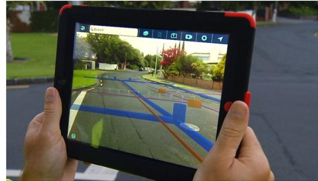
Darstellung verschiedener Leitungsnetze im Kamerabild eines Tablet-PC (Quelle: AUGVIEW)
